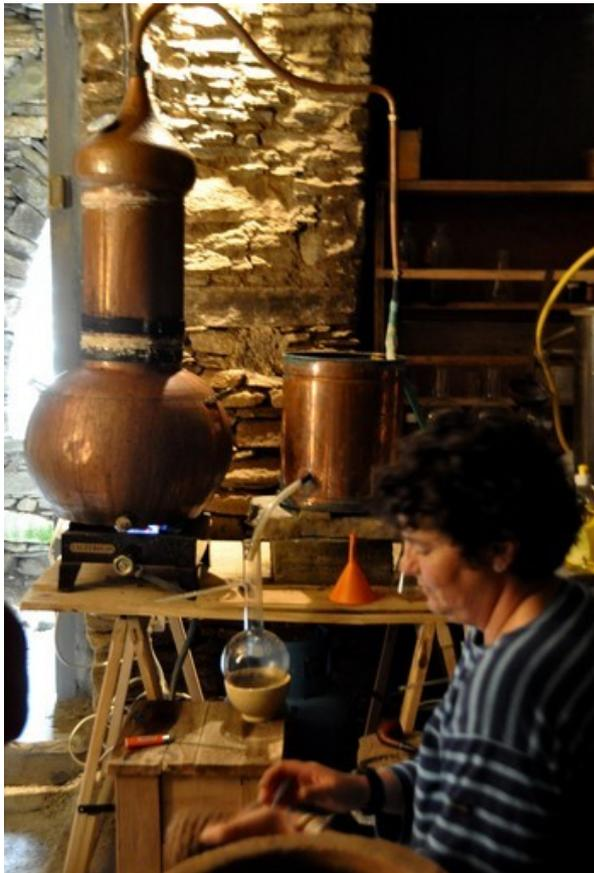
Et hop, sur le feu ! Les 3 litres d'eau préalablement mis dans la chaudière de l'alambic vont se vaporiser, pénétrer dans le cylindre et se charger de molécules aromatiques. Les vapeurs riches vont être condensées en passant dans le réfrigérant et le distillat, mélange d'HE et d'hydrolat, sera récupéré dans le ballon florentin.
