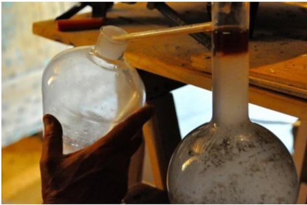
L'HE monte dans le col du ballon, Il est temps de la récupérer dans une ampoule à décanter.
