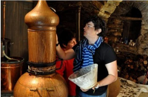
Et on lute le chapiteau de l'alambic sur le cylindre à l'aide d'une pâte formée de farine et d'eau, La vapeur ne pourra pas ainsi s'échapper de la machine.
