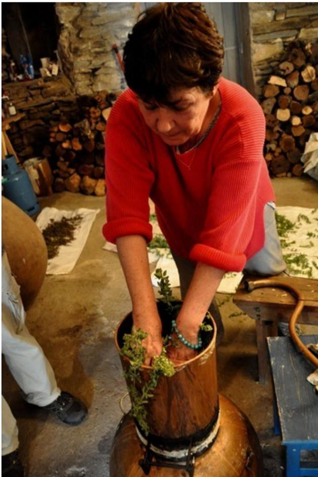
De retour à la distillerie on charge le cylindre de l'alambic avec 4 à 5 Kg de fleurs. On distille par entraînement des molécules à la vapeur d'eau : les fleurs ne sont pas en contact avec le liquide, seule la vapeur travaille.
